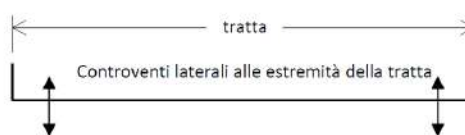
CONTROVENTATURE LATERALI MINIME IN TRATTA
